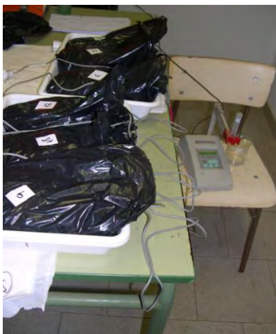
■ ■ ■ Figura 1.- Ensayo de estabilidad aerobia en ensilados de maíz
